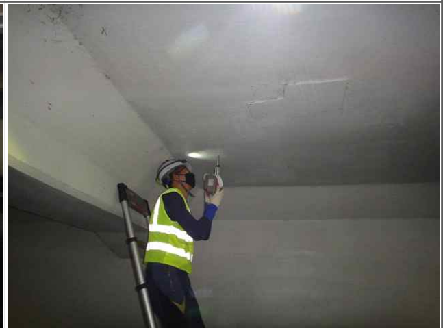
사다리를 이용한 근접조사(비파괴시험)
